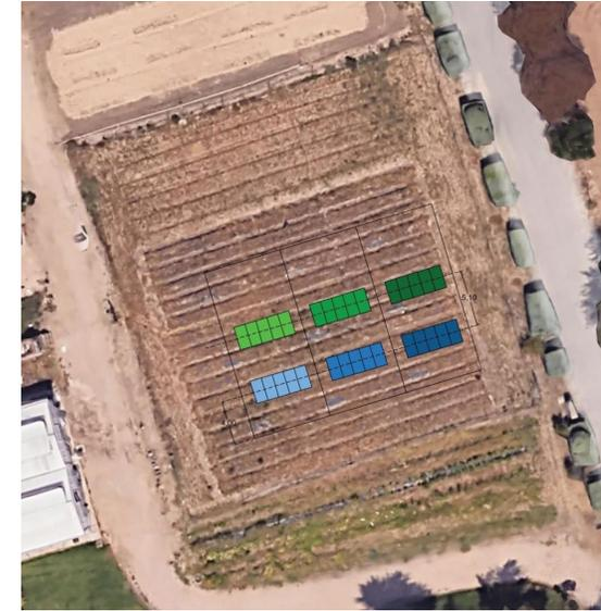
Figura 2: Plano de situación de los paneles fotovoltaicos nuevos y reutilizados sobre el terreno.
